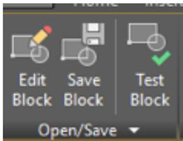
La otra forma de guardar los cambios es ir directamente a la pestaña “Block Editor” y en el *Panel de “Open/ Save”* encontraremos las opciones de *Guardar Bloque Como (Save Block As)* que permitirá renombrar el bloque. Así tendremos dos bloques totalmente diferentes.
